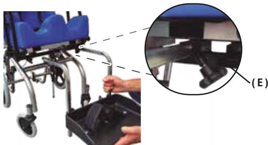
Encaixe o apoio de pés abaixo do assento **(E)**. Regule sua altura e profundidade. Para ajustar a altura e profundidade do apoio de pés, deixe solto os 4 manípulos e só aperte após definir a posição desejada.
