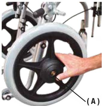
Encaixe a roda traseira apertando o pino **(A)**, empurre-a até o fim e solte o pino. Verifique se a roda ficou presa. Para retirá-la, aperte o pino **(A)** novamente e puxe-a.
