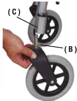
Para colocar a roda dianteira, aperte o pino **(B)** encaixe no eixo do rolamento **(C)** e empurre até o fim. Solte o pino e verifique se ela ficou presa. Para retirá-la, aperte o pino e puxe-a.
